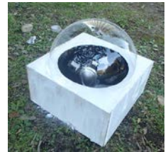
二酸化炭素測の人工衛星の検証のために開発した小型の地上計測装置。
