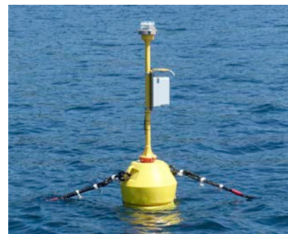
大槌湾の係留ブイでシースプレー測器の試験をしている様子。
