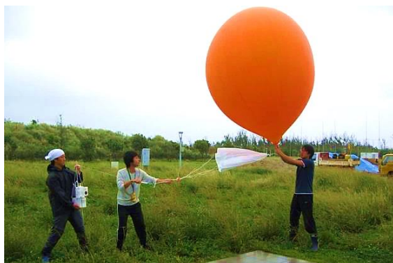
上: 雲解像モデルにより再現された積乱雲群とそれを構成する雲・降水粒子およびそれに伴う雷。図中の写真は存在が想定される粒子のイメージ。 下: 顕微鏡を搭載した気球による台風の雲の観測。放球風景(左図)と得られた雲粒子(右図)の例。
