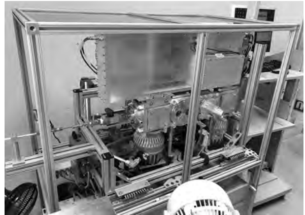
微粒子化したエアロゾル抽出物の分析に用いたエアロゾル質量分析計。
