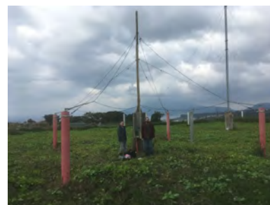
鹿児島観測所に設置された雷からの電磁波動を観測するジョージア工科大学の受信機。背景は桜島。
