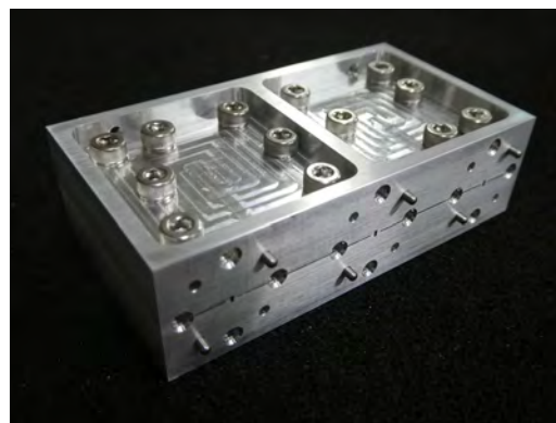
開発した導波管型マルチプレクサ。
