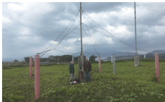
米国・ジョージア工科大学が鹿児島観測所に設置した ELF/VLF 帯電波の受信機
