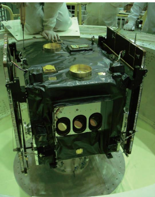
いますが、これは衛星固有の最適な温度環境を保持し続けるため外部(宇宙空間や太陽光)と衛星本体を熱的に遮断する役目を果たしています。また、荷電粒子からなる宇宙プラズマの中を飛翔したときに、荷電粒子が当たって局所的に帯電したり放電しないように導電性になっていません(私たちが冬にバチッと光って痛い静電気で悩まされますよね)。
