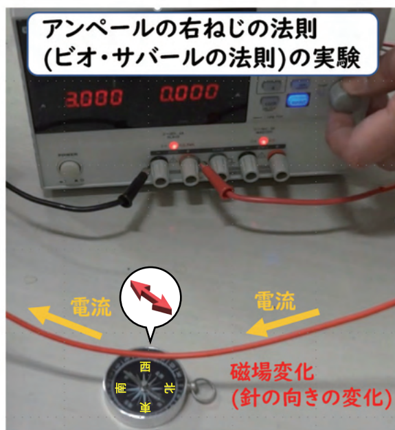
図2. (左)アンペールの右ねじの法則(ビオ・サバールの法則)の実験風景。(右)地上で磁場変動を計測すれば、遠くジオスペースで流れている大電流の様子を推定することができる。
