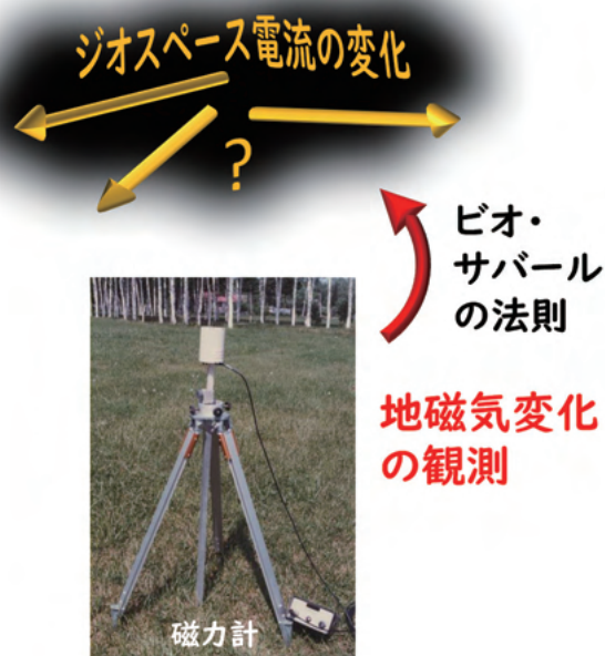
図2. (左)アンペールの右ねじの法則(ビオ・サバールの法則)の実験風景。(右)地上で磁場変動を計測すれば、遠くジオスペースで流れている大電流の様子を推定することができる。
