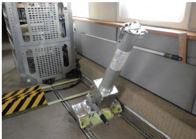
図6. ジェット機G-IVのキャビン内のドロップゾンデ観測システムの投下装置。後方の金属ラックは受信機の一部。令和3年度総長裁量経費により設置。
