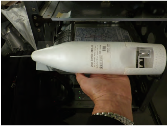
図2. 台風の航空機観測で使用するドロップゾンデの本体（明星電気株式会社製）。右端に温度と湿度センサーが見える。こちら側が下になって落下し、上空から海面までの温度、湿度、気圧、風向・風速、高度を測定する。ボディは生分解性素材でできている。
