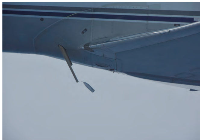
図7. 高度2万フィートで実施したドロップゾンデの投下試験。高速度カメラでドロップゾンデの射出の瞬間を捉えたもの。(ダイヤモンドエアサービス社提供)
