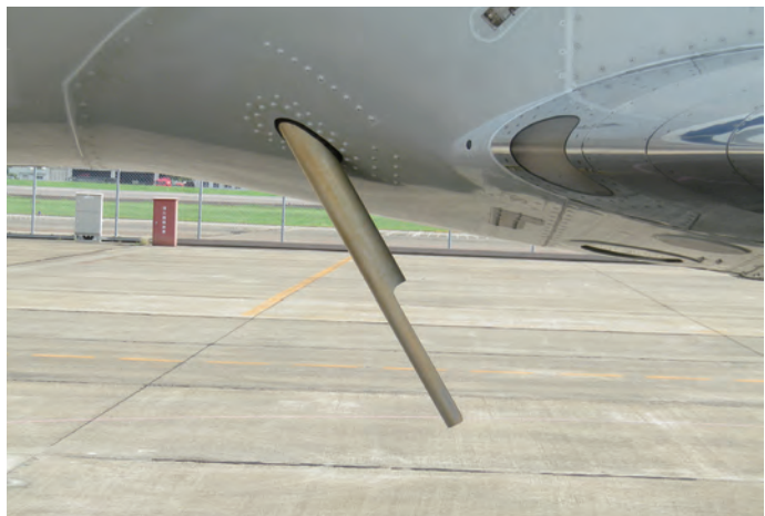
図5. ジェット機G-IVの主翼付け根部に設置したドロップゾンデ観測システムの射出口。令和3年度総長裁量経費により設置。
