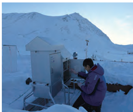
写真2. ゼッペリン山(写真奥)の麓の観測所における観測の様子。ポンプで大気を吸引してフィルタにエアロゾルを採取し、日本に持ち帰って分析します。
