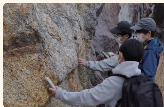
簡易放射線測定器で苗木花崗岩の放射線量を測定
