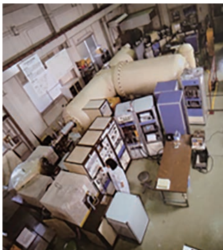
(左) 図3-1. タンデロン1号機: 1981年導入 General Ionex Corporation Model 4130A (2.5 MV) 日本に導入された ^{14}\text{C} 専用AMS装置第1号。中村俊夫先生(名古屋大学名誉教授)が中心となり、活発に共同研究を推進し、数多くの ^{14}\text{C} 論文を生み出しました。老朽化のため、2021年に廃棄しました。
