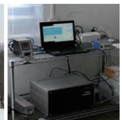
母子里観測所に設置している大気ブラックカーボンの計測装置
