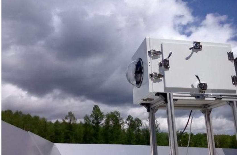
図4:なよろ市立天文台に設置されている夜光雲監視用定点カメラシステム。
