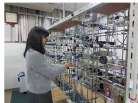
CO 2 精製ライン。 CO 2 purification line.
