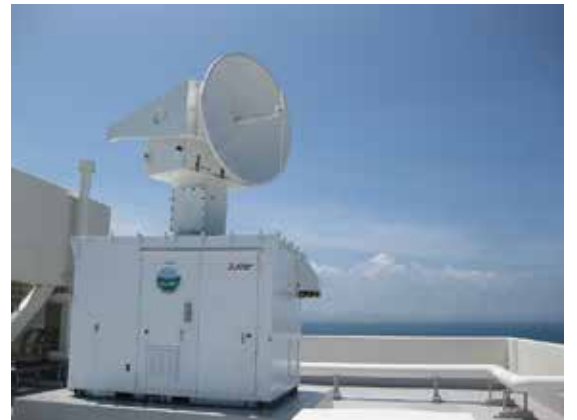
Ka-バンド雲レーダ。 Ka-band cloud radar.
