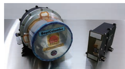
日欧国際共同による水星探査用宇宙機に搭載される高エネルギー粒子分析器。 High-energy particle instruments for a Mercury exploration mission based on an EU-Japan international collaboration.
