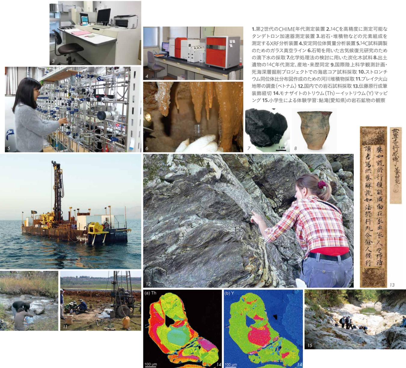
1.第2世代のCHIME年代測定装置 2.14Cを高精度に測定可能なタンデトロン加速器測定装置 3.岩石・堆積物などの元素組成を測定するXRF分析装置 4.安定同位体質量分析装置 5.14C試料調製のためのガラス真空ライン 6.石筍を用いた古気候復元研究のための地下水の採取 7.化学処理法の検討に用いた炭化木試料 8.出土遺物の14C年代測定、産地・来歴同定 9.国際陸上科学観測計画・死海深層掘削プロジェクトでの海底コア試料採取 10.ストロンチウム同位体比分布図作成のための河川堆積物採取 11.プレイク火山地帯の調査(ベトナム) 12.国内での岩石試料採取 13.伝藤原成筆装飾経切 14.モナザイトのトリウム(Th)-イットリウム(Y)マッピング 15.小学生による体験学習:鮎滝(愛知県)の岩石鉱物の観察
