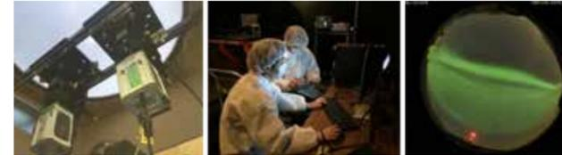
北欧、北米に設置した 100Hz 高速撮像カメラによるオーロラ観測。
