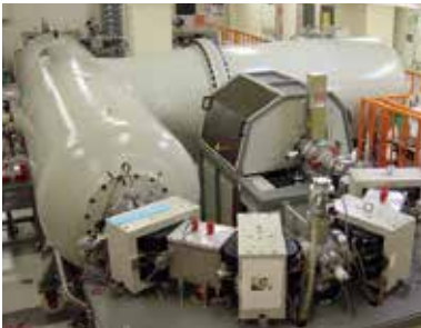
図 1. 14 C 測定用の加速器質量分析装置
