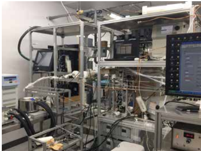
エアロゾル粒子の吸湿成長度と雲凝結核活性を測定するための装置群 (HTDMA, CCNC 等)
