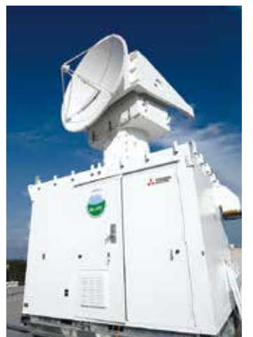
（上）2013 年 6 月 15 日にパラオ共和国で放球された雲粒子ゾンデ HYVIS により取得された雲粒子と固体降水粒子の画像 （右）名古屋大学に設置されている Ka バンド雲レーダ
