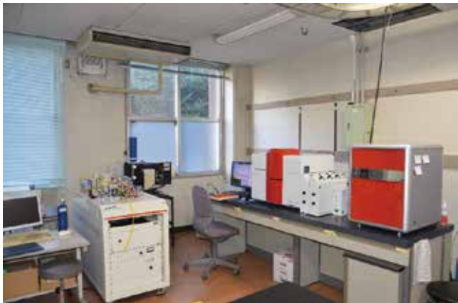
図 3. 安定同位体質量分析装置 (左: デュアルインレット方式、右: 高温熱分解装置を備えた連続フロー式)
