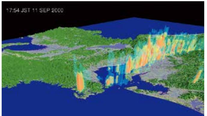
中部電力三国山レーダにより取得された東海豪雨発生時（2000年9月11日17時54分）のレーダ反射強度の3次元分布。水色→黄色→橙色と変化するほど強い雨が存在することを示す。地上の赤い点は東海市の位置を示す。
