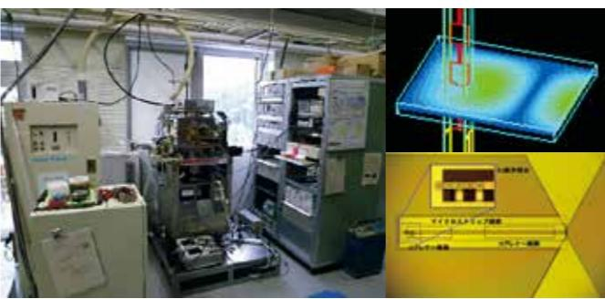
北海道の陸別観測所に設置されたミリ波分光計（左）、電磁界解析による導波管回路の電波伝搬の計算（右上）、超伝導SIS素子中心部の顕微鏡写真（右下）
