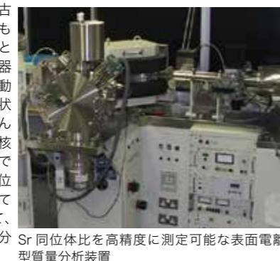
Sr 同位体比を高精度に測定可能な表面電離型質量分析装置
