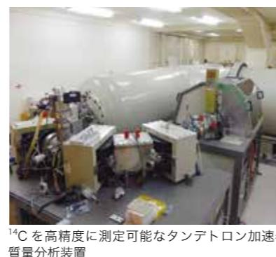
$^{14}\text{C}$  を高精度に測定可能なタンデトロン加速器質量分析装置
