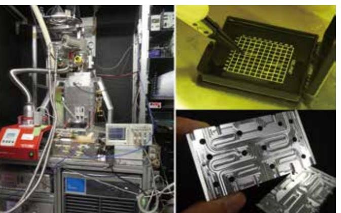
ノルウェーに設置したミリ波ラジオメータの外観（左）。大学院生と共に設計開発を行った超伝導検出素子（右上）および導波管型周波数分配器（右下）
