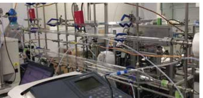
エアロゾル粒子をオゾンに曝露する反応実験のための装置
