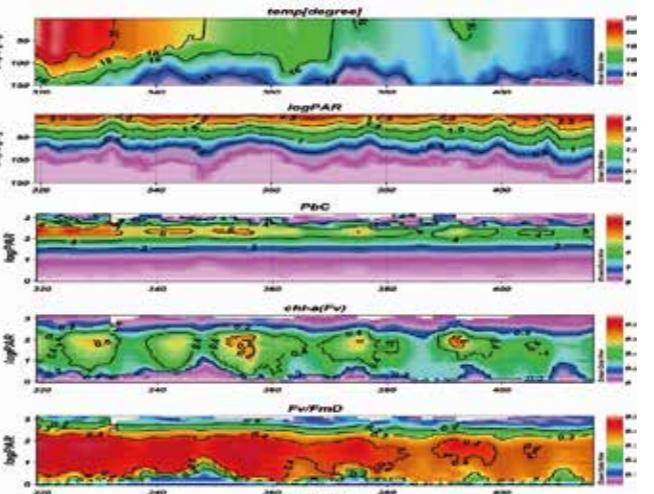
高速フラッシュ励起蛍光光度計(FRRF, 左写真)を搭載した係留観測システムで取得した時系列データ。3-5段目: クロロフィル量、光合成速度、PS II の最大量子率收容
