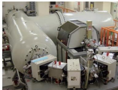
図1. <sup>14</sup>C測定用の加速器質量分析装置
