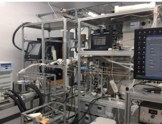
エアロゾル粒子の吸湿成長度と雲凝結核活性を測定するための装置群 (HTDMA, CCNC 等)
