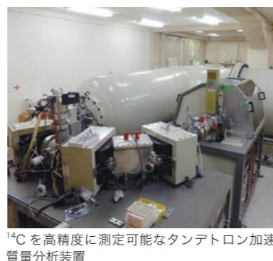
$^{14}\text{C}$  を高精度に測定可能なタンデットロン加速器質量分析装置
