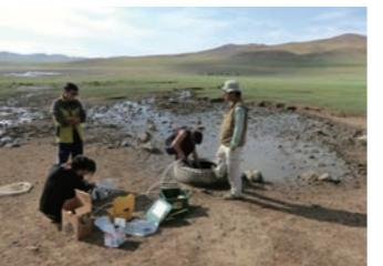
地球温暖化によって、東シベリアとモンゴルでは永久凍土表層の融解が進んでいます。現地の湧水を探取し、湧水中のトリチウム濃度やフロン類の濃度を分析することで、凍土に含まれる地下氷がどのくらい融解しているかを調べています。
