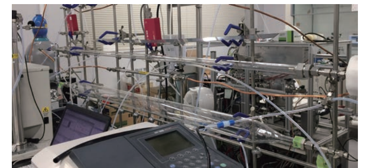
エアロゾル粒子をオゾンに曝露する反応実験のための装置
