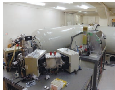
^{14}\text{C} を高精度に測定可能なタンデム加速器質量分析装置
