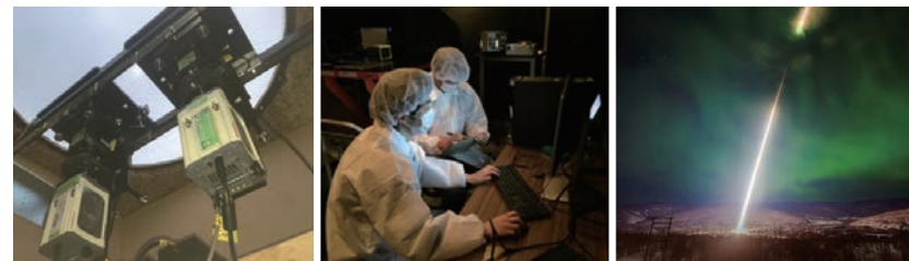
左・中：北欧、北米に設置した100Hz高速撮像カメラによるオーロラ観測
