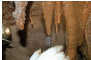
石筍を用いた古気候復元のための滴下水の分析
