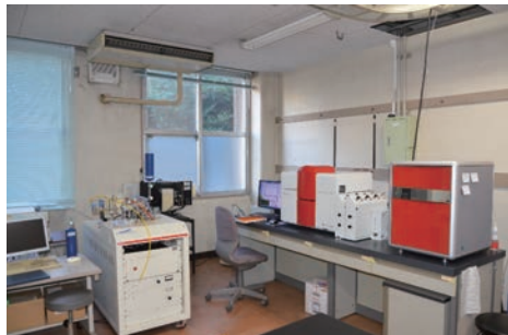
安定同位体質量分析装置 (左:デュアルインレット方式、右:高温熱分解装置を備えた連続フロー式)
