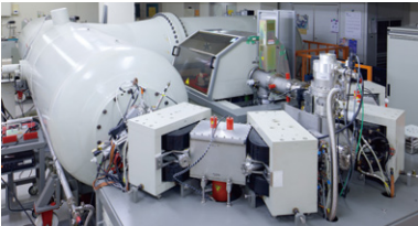
ISEEに設置されている高精度・高確度炭素14測定を行う タンデントロン加速器質量分析計(オランダHVEE社製)
