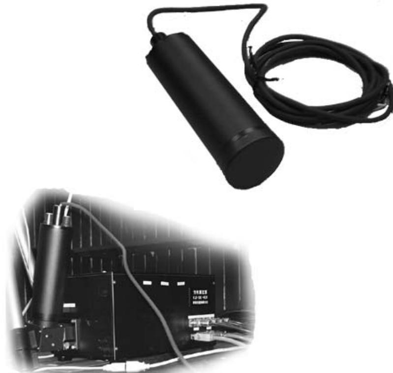
図 2.13. 観測サイトにてフォトメーターの強度較正を行う標準光源。フォトメーター採光部に取り付けられる。
