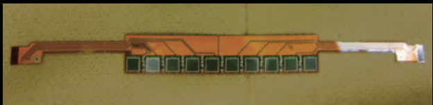
プラスチックシンチレータ読み出し用基板に搭載された10個の浜松ホトニクス社製MPPC(1個6.35mmx7.35mm)
